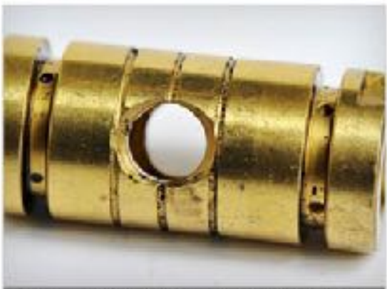
Las partículas de gran tamaño en el aceite pueden causar impactos y mucosas profundas
