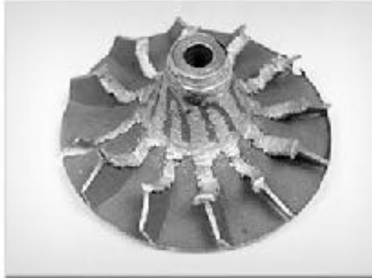
Rueda del compresor deteriorada
