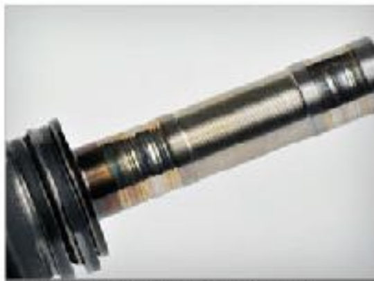
Cojinete desgastado y rayado, con transferencia de materiales en el eje
