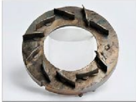
Daño en conjunto de álabes de geometría variable
